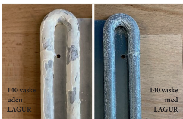
Uden kemi nedbryder LAGUR kalkens evne til at aflejre sig. LAGUR omdanner kalkens form fra skarpe krystaller til runde granuler, så du ikke får kalkaflejringer i hvidevarer og på overflader.
